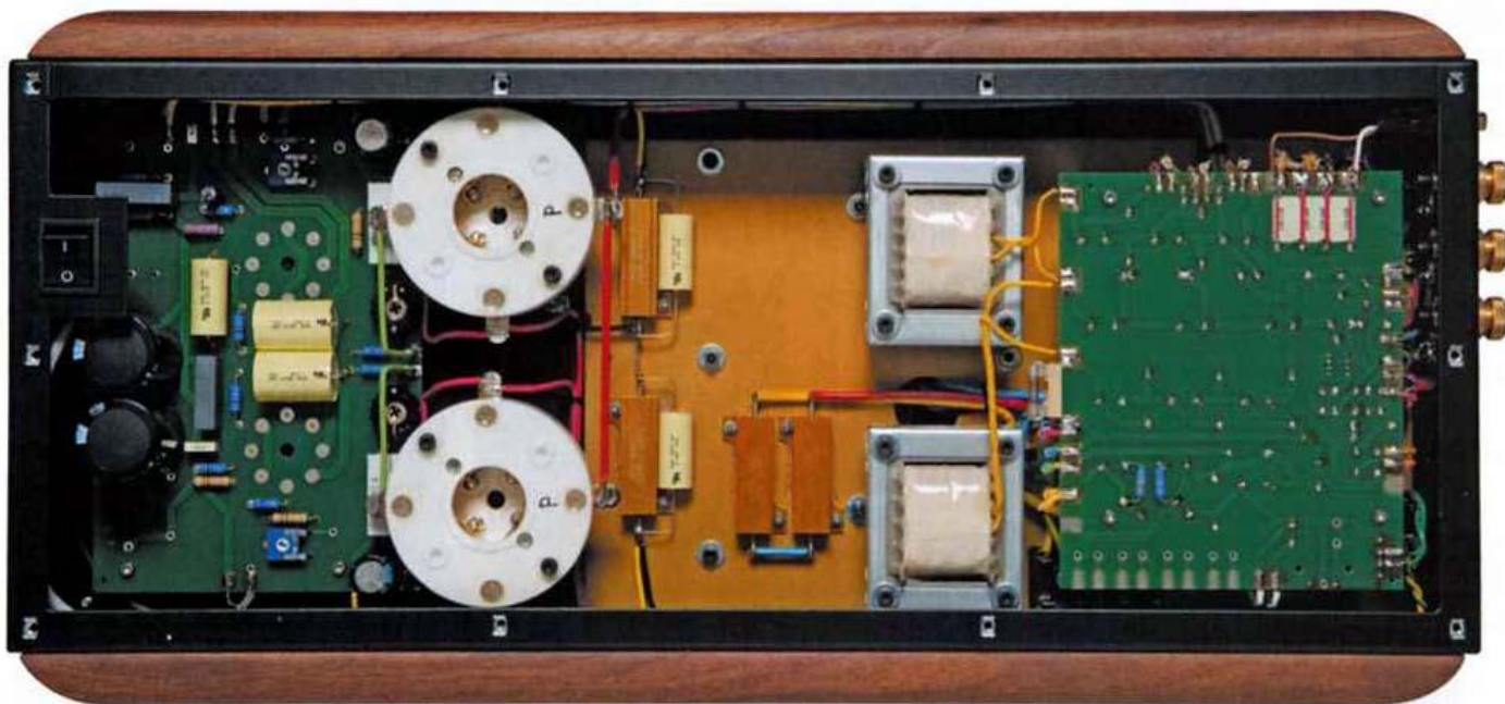
Les condensateurs de filtrage de l'alimentation haute tension sont soudés sous le circuit en époxy, à droite.
