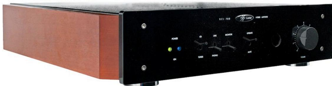
VFI-700 mm est un amplificateur intégré hybride à alimentation principale externe, offrant une entrée phono MM et trois autres entrées haut niveau et deux sorties une fixe et une variable.
