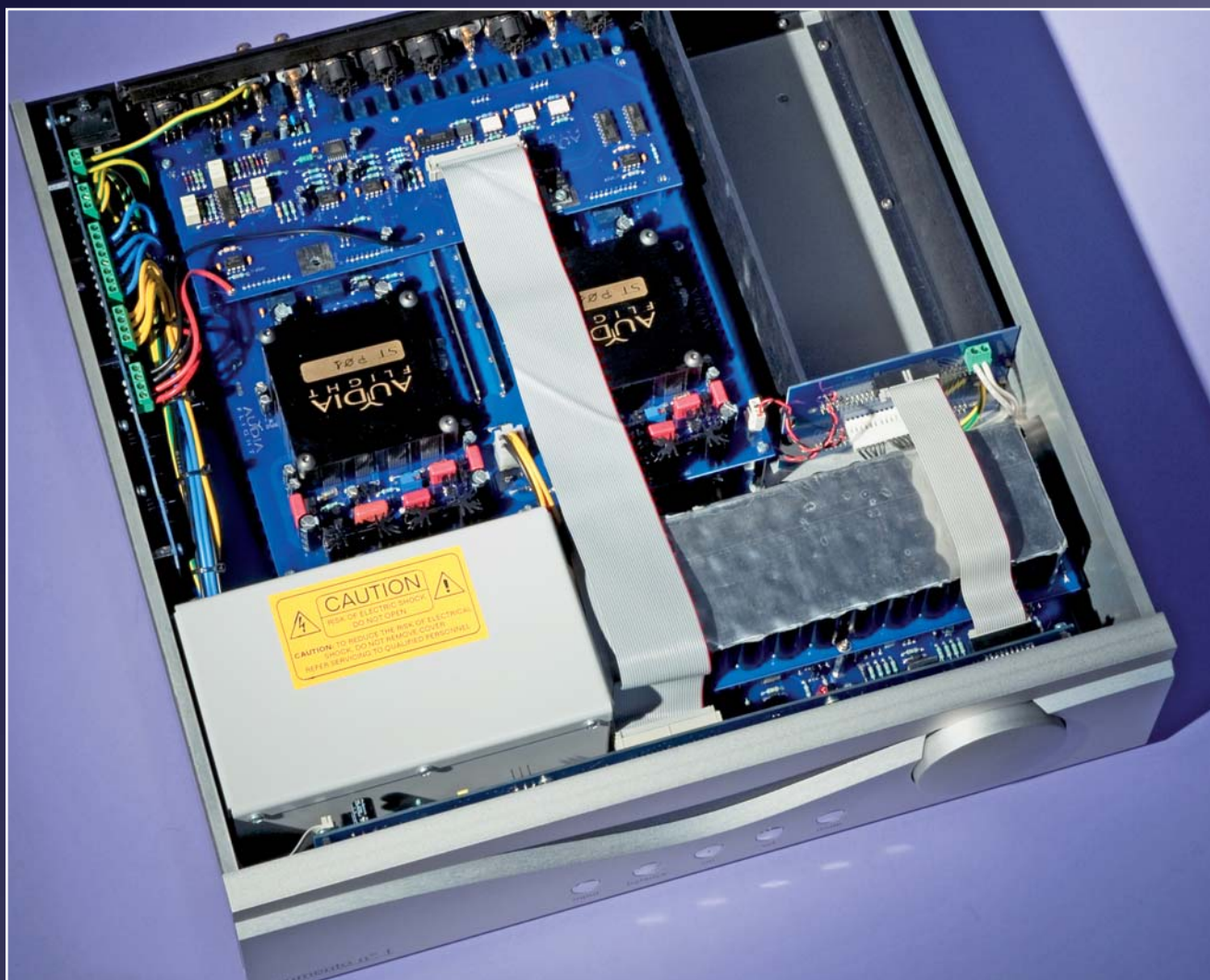
On distingue au centre du Strumento n° 1 les deux modules Audia du canal gauche, le boîtier de blindage du transformateur d'alimentation en bas à gauche et la banque de condensateurs d'alimentation à droite. Câblage filaire minimum.
