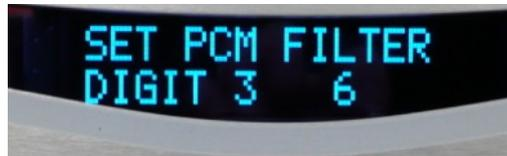
Chacun des 6 filtres ne s'applique qu'au signal PCM et a ses propres fréquence d'intervention et pente. Son action est montrée sur la réponse à une impulsion ; elle a un effet sur la restitution commentée dans le tableau en page 6.
