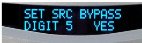
Entrez dans la rubrique par **SET** puis affichez, si elle ne l'est pas, l'entrée USB (DIGIT 5) par + ou -. Une action sur **SET** produit le clignotement de **NO** ou **YES** pouvant être échangé par + ou -. Une fois effectué, le choix est validé au bout de quelques secondes après l'arrêt du clignotement.
