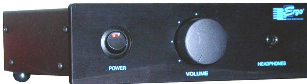
L'AMP ERGO 1 est, dans un élégant coffret, un amplificateur universel destiné à alimenter tous les casques dynamiques munis d'une fiche de 6,3 millimètres tels que les ERGO 1 et ERGO 2. La puissance de sortie de 3,5 watts garantit une reproduction de musique propre, exempte de distorsions ou de coloration.
