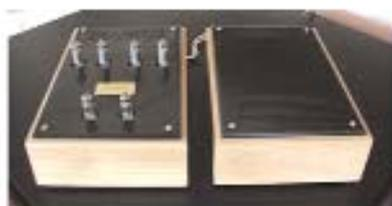
Amplificatore a valvole push-pull senza controreazione e accoppiamenti interstadio realizzati esclusivamente con trasformatori in argento: la soluzione alle limitazioni degli amplificatori single ended
