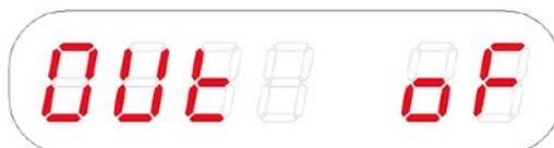
Une action sur IN+ fait passer l'entrée IN 1 en sortie et l'affichage devient **Out on**. L'action sur IN- rétablit IN 1 en entrée.
