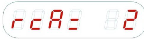
L'action sur IN+ fait passer à 3 puis à 4 le nombre d'entrées asymétriques par conversion à ce format de IN 3 puis de IN 4. À noter que pour être effective cette modification nécessite l'emploi d'un ou deux adaptateurs XLR/RCA sur chaque canal.
