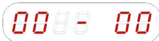
L'action sur IN+ incrémente le canal gauche de l'afficheur sur une échelle de 00 à 20 correspondant à la diminution proportionnée du volume sonore sur le canal droit jusqu'à l'équilibre désiré. L'action sur IN- décrémente l'affichage précédent jusqu'au retour à l'affichage initial. Si l'action est poursuivie, elle incrémente le canal droit de l'afficheur pendant que le niveau sonore du canal gauche diminue symétriquement. La confirmation est faite par appui sur PRG.
