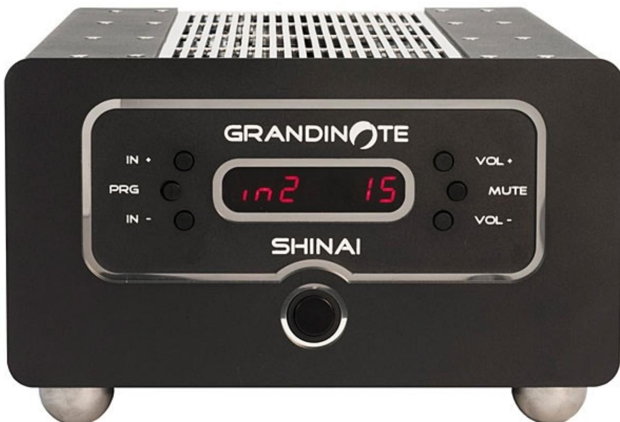
De part et d'autres de l'afficheur à LED à 7 segments, 6 boutons poussoirs permettent le réglage du volume ou la mise en sourdine, la sélection de l'entrée ainsi que la configuration. Le commutateur central assure la mise en fonction ou l'arrêt. L'afficheur indique l'entrée sélectionnée et le niveau du volume.
