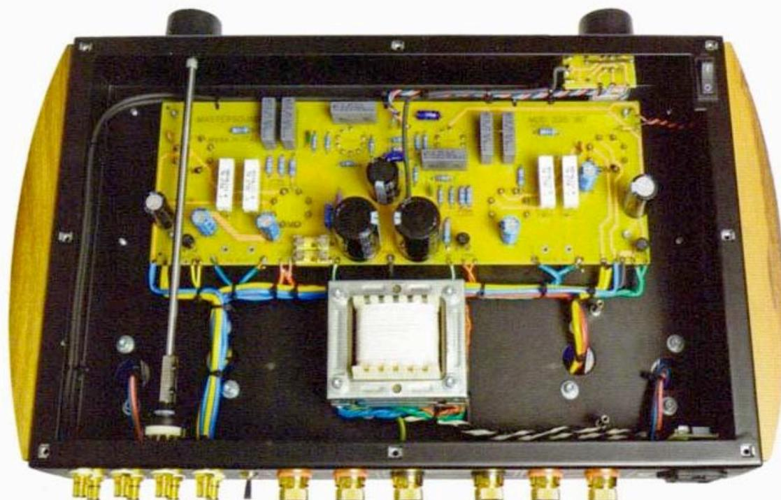
Sur la photo du haut, on constate que le Dueventi adopte désormais une esthétique similaire à celle des autres électroniques Mastersound. L'implantation des circuits est absolument remarquable d'évidence et de simplicité. La connectique est de grande qualité. Les tensions d'alimentation des filaments sont issues du transformateur central.
