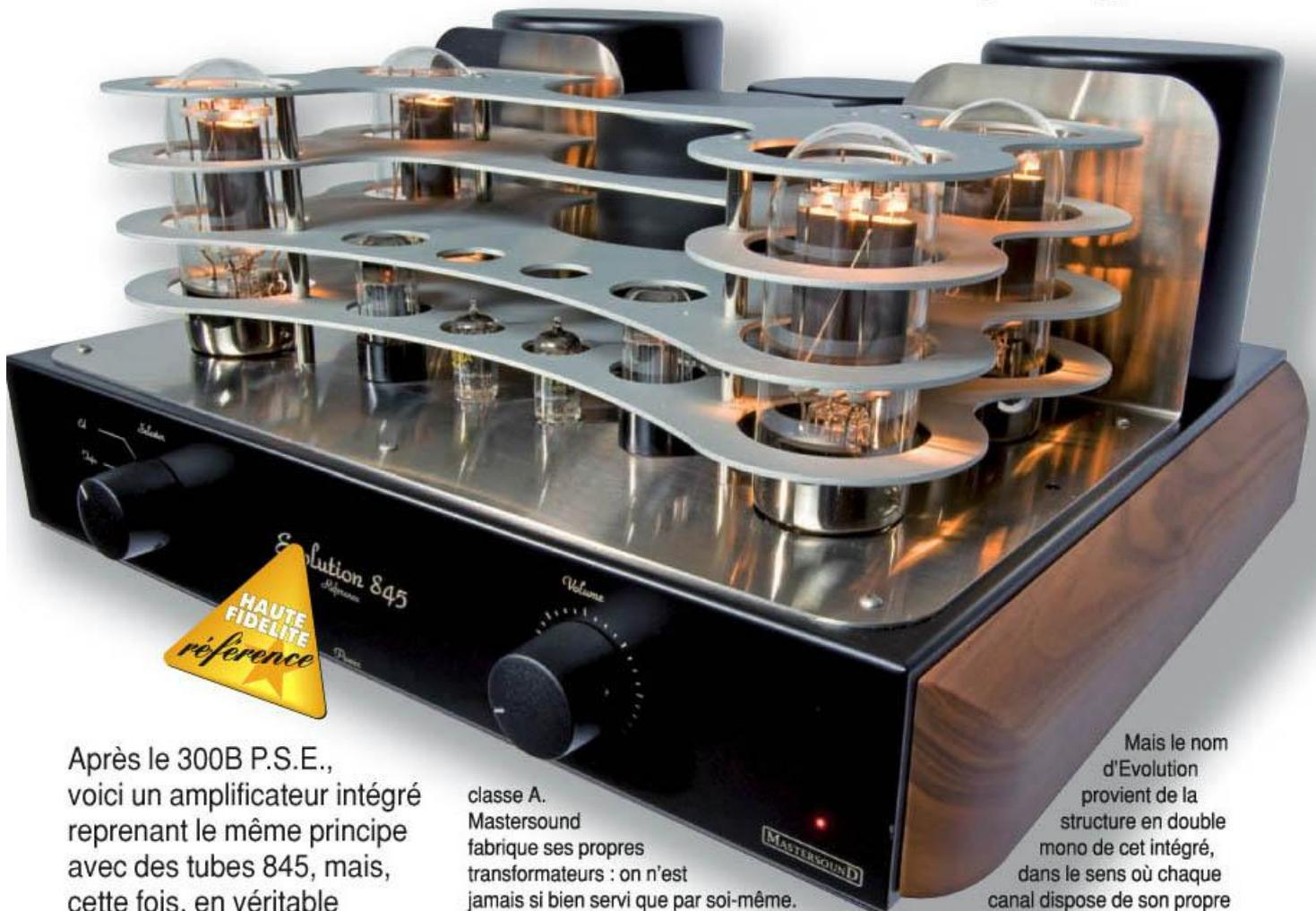
Après le 300B P.S.E., voici un amplificateur intégré reprenant le même principe avec des tubes 845, mais, cette fois, en véritable structure double-mono.
